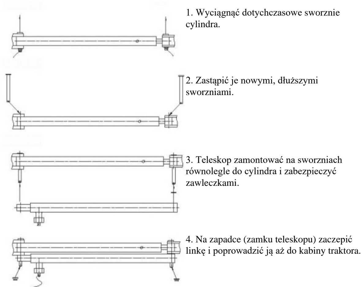
Rys. 11 Sposób mocowania zabezpieczenia
