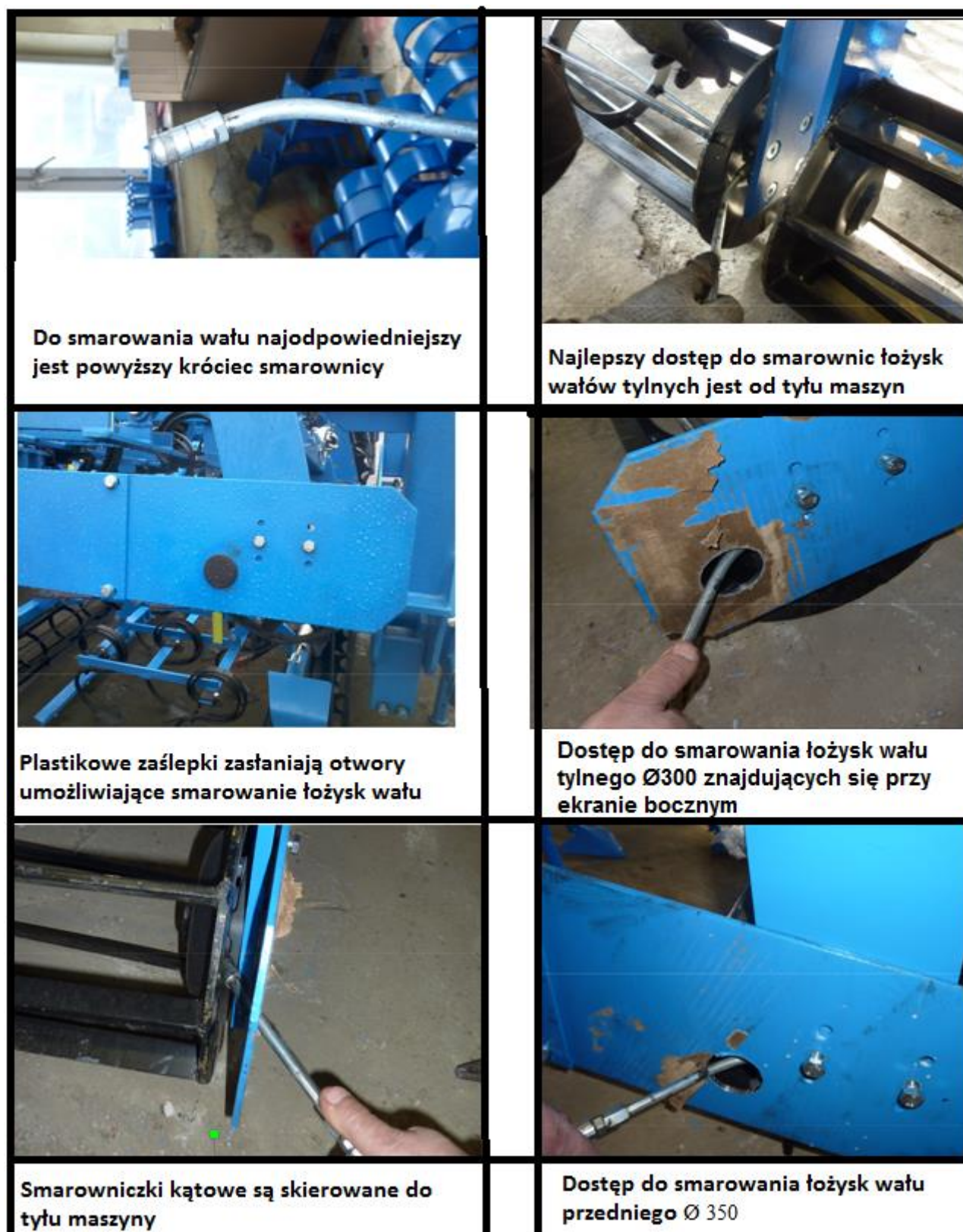
Rys. 18 Smarowanie trudno dostępnych punktów w agregacie przewidzianym SHARP
